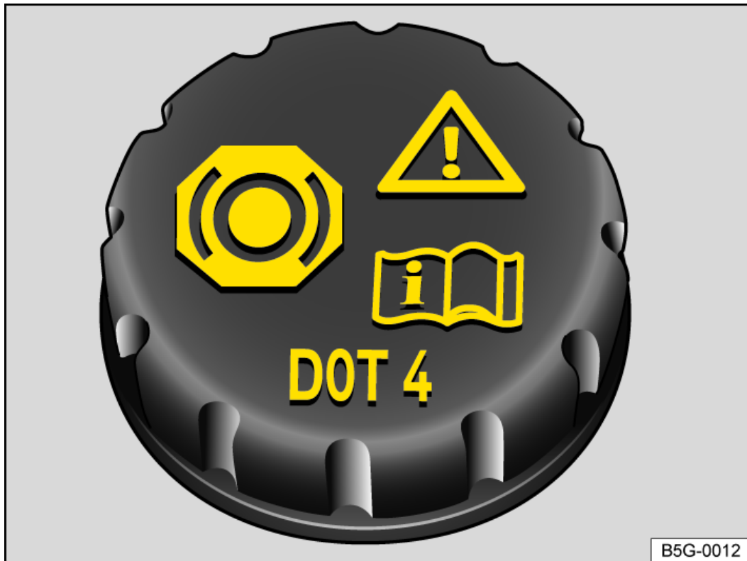
Abb. 1 Im Frontraum: Deckel des Bremsflüssigkeitsbehälters.
