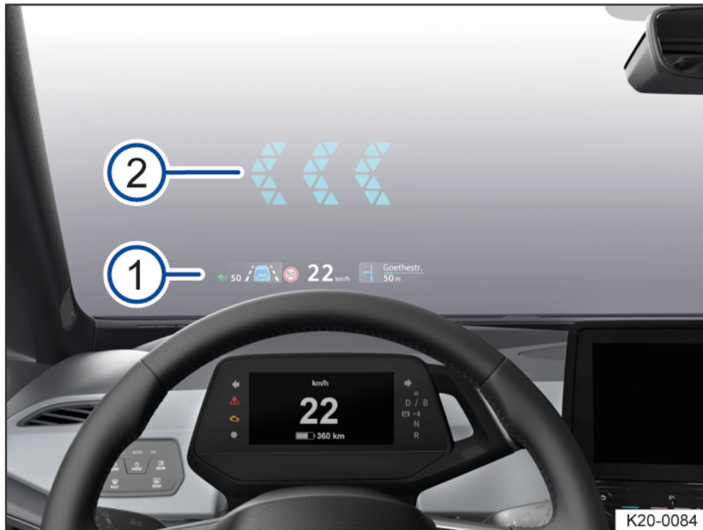
Abb. 1 Im Sichtfeld des Fahrers: HUD-Nahbereich (1) und AR-HUD (2).
