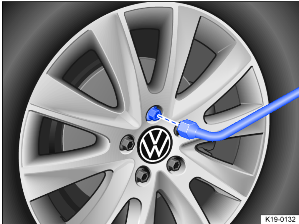
Abb. 1 Radwechsel: Radschrauben mit dem Radschlüssel abschrauben.
