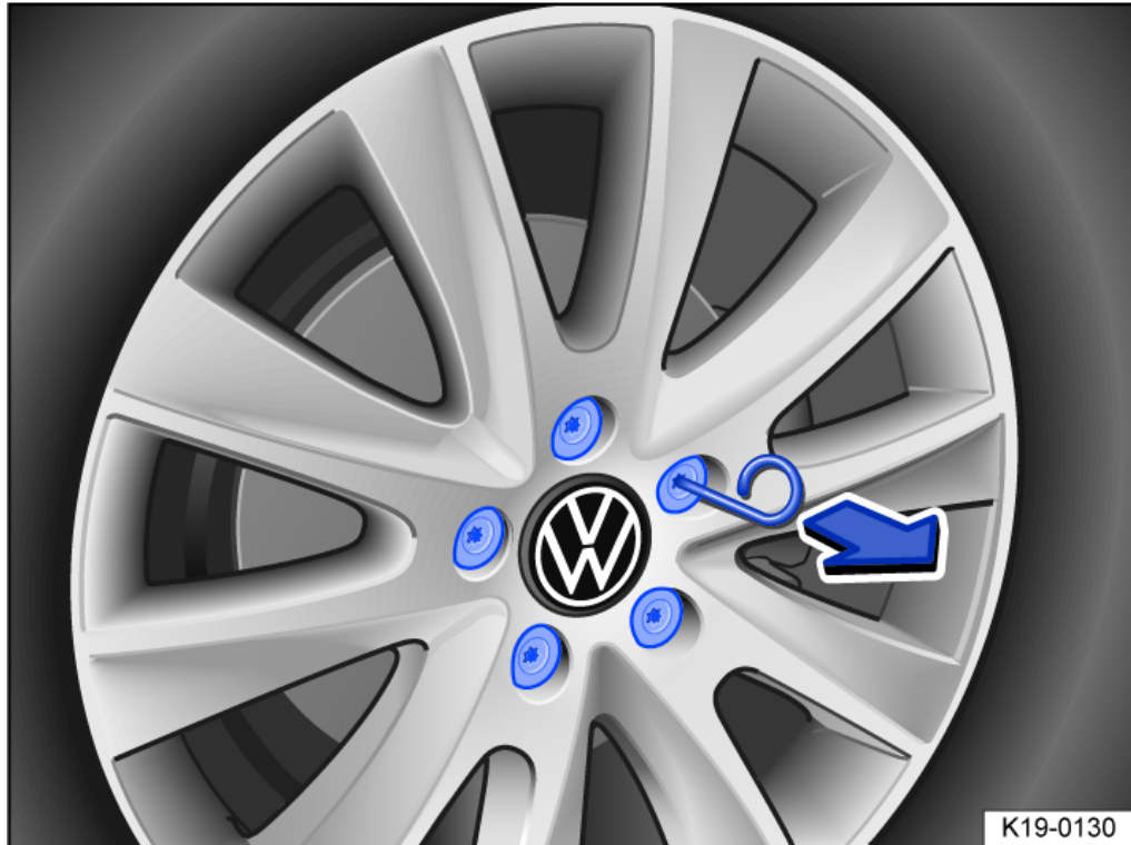
Abb. 1 Abdeckkappen von den Radschrauben abziehen.
