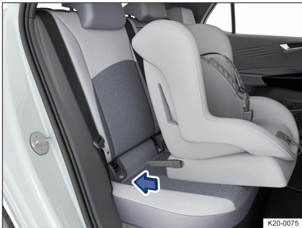
Abb. 4 Prinzipdarstellung: Kindersitz mit Rastarmen einbauen.
