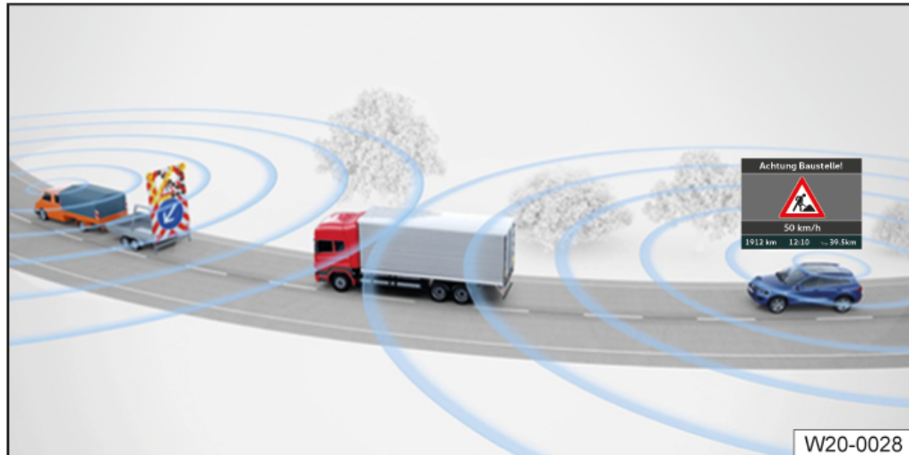
Abb. 1 Prinzipdarstellung: Gefahrenwarnung durch eine Tages- oder Wanderbaustelle.
