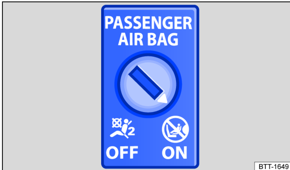
Abb. 1 In der Instrumententafel auf der Beifahrerseite: Schlüsselschalter zum Ab- und Einschalten des Beifahrer-Frontairbags.
